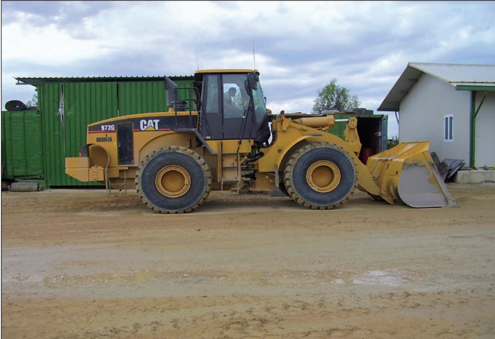
Pala meccanica con protezione antiribaltamento e cabina insonorizzata e climatizzata
