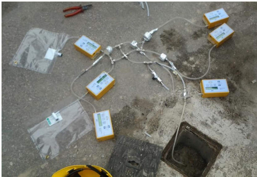
Figura 9 e): Applicazione degli schemi tipo linea di campionamento soil gas di Fig 9 c) e 9 d).
