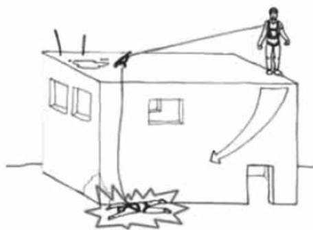
b) effetto pendolo e scivolamento lungo il bordo
